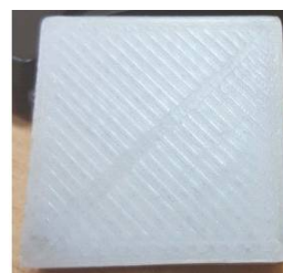
Рис. 10. Внешний вид поверхности тестового изделия, отпечатанного из нейлона
