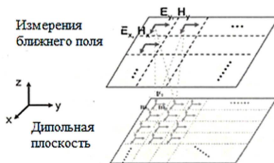
Модель эквивалентного источника с использованием дипольной матрицы
